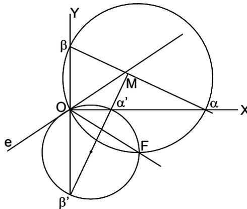
El foco común de las parábolas  $(P)$  y  $(P')$  es el punto de intersección  $F$  de las circunferencias circunscritas a los triángulos  $O\alpha\beta$  y  $O\alpha'\beta'$ , de acuerdo con la construcción del foco de una parábola de la que se conocen tres tangentes y el punto de contacto de una de ellas. La dirección común del eje de estas parábolas es la simétrica de la recta  $OF$  respecto a  $OX$ , o bien respecto a  $OY$ .
