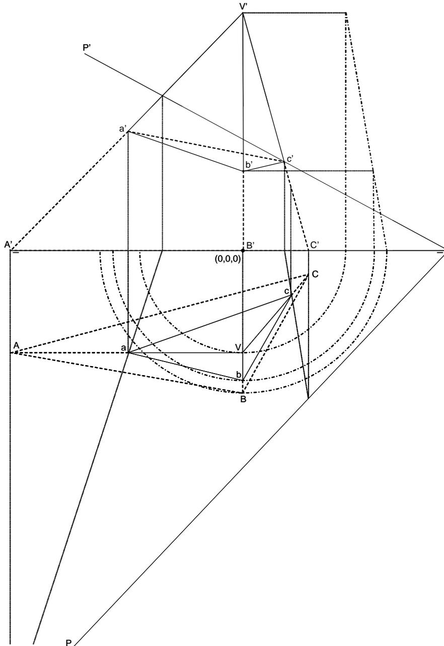
Se ha supuesto que el plano dado es opaco, por lo que se ha dibujado de trazos la parte de la pirámide situada debajo del plano. La proyección de la sección es el triángulo  $abc$ , y la vertical, el  $a'b'c'$ . Recordar que la base y la sección son homológicas, con eje de homología la traza del plano y centro de homología el vértice de la pirámide. Sus proyecciones horizontales también lo son, con eje de homología la traza  $P$ , y centro de homología  $V$ .
