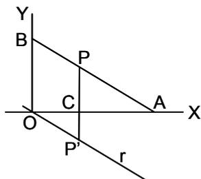
Sean  $OX$  y  $OY$  las rectas perpendiculares. Se traza por  $O$  la paralela  $r$  a  $AB$ . Sea  $P'$  el punto en que la perpendicular  $PC$  a  $OX$  corta a  $r$ . Los triángulos  $PAC$  y  $P'OC$  son semejantes, luego  $\frac{CP}{CP'} = \frac{PA}{P'O}$ . Por tanto  $P$  describe la elipse afín a la circunferencia de centro  $O$  y radio  $OP'$ , y cuyos ejes son  $OP' = BP$  y  $PA$ .
