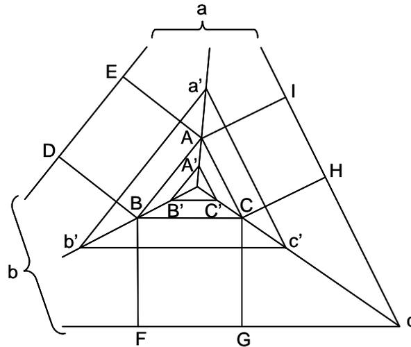
Los triángulos  $ABC$  y  $abc$  son homotéticos, con centro de homotecia el punto  $K$  de Lemoine (intersección de las simedias), siendo la razón  $\rho = 1 + \frac{a'^2 + b'^2 + c'^2}{2S'}$ , siendo  $a'$ ,  $b'$  y  $c'$  los lados del triángulo  $abc$ , y  $S'$  su superficie.
