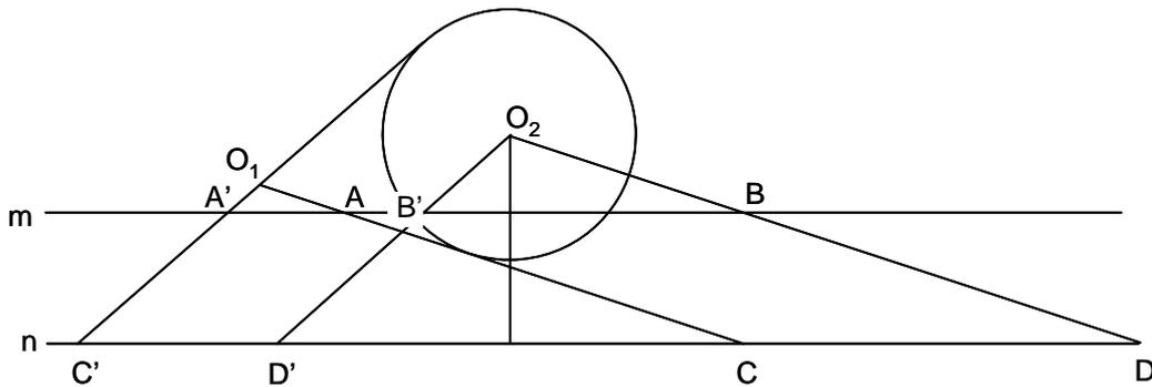
Se traza con centro  $O_2$  una circunferencia de radio la distancia entre las dos paralelas  $m$  y  $n$ . Se trazan por  $O_1$  las tangentes  $O_1C$  y  $O_1C'$ , y por  $O_2$  se trazan las paralelas a las tangentes,  $O_2D$  y  $O_2D'$ . Los rombos son  $A'C'D'B'$  y  $ACDB$ , pues la distancia entre los lados opuestos es igual a la distancia entre  $m$  y  $n$ .
