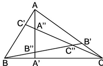
Sean  $a$ ,  $b$  y  $c$  los lados del triángulo  $ABC$ , y sean  $a' = AA'$ ,  $b' = BB'$  y  $c' = CC'$ . Se tiene  $a'^2 = \frac{m^2}{(m+n)^2} a^2 + c^2 - \frac{2mac \cos B}{m+n}$ . Como  $-2ac \cos B = b^2 - a^2 - c^2$ , se tiene que:
