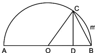
Los volúmenes engendrados son, respectivamente,  $V = \frac{4}{3}\pi R^3$ ,  $V_1 = \frac{\pi}{3}Rx^2$ ,  $V_2 = \frac{2}{3}\pi R^2x$ .
