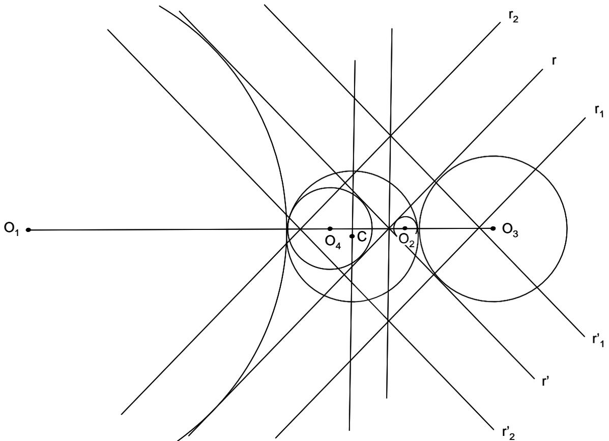
Disminuyendo el radio de  $C$ , de forma de convertirla en un punto, y trasladando las rectas dadas paralelamente a sí mismas en una distancia igual al radio de  $C$ , el problema se reduce a trazar una circunferencia que pase por un punto y sea tangente a dos rectas dadas (E 14). En total hay ocho soluciones.
