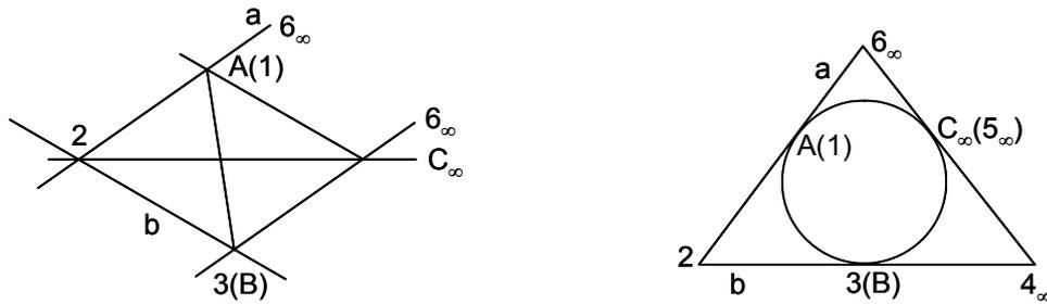
La obtención de  $B$  se expone en la figura. Se deduce de ella la siguiente propiedad de la parábola: el punto del infinito de una parábola está determinado por la recta que une un punto cualquiera con el punto medio de la recta que une los puntos de contacto de las tangentes trazadas desde él.
