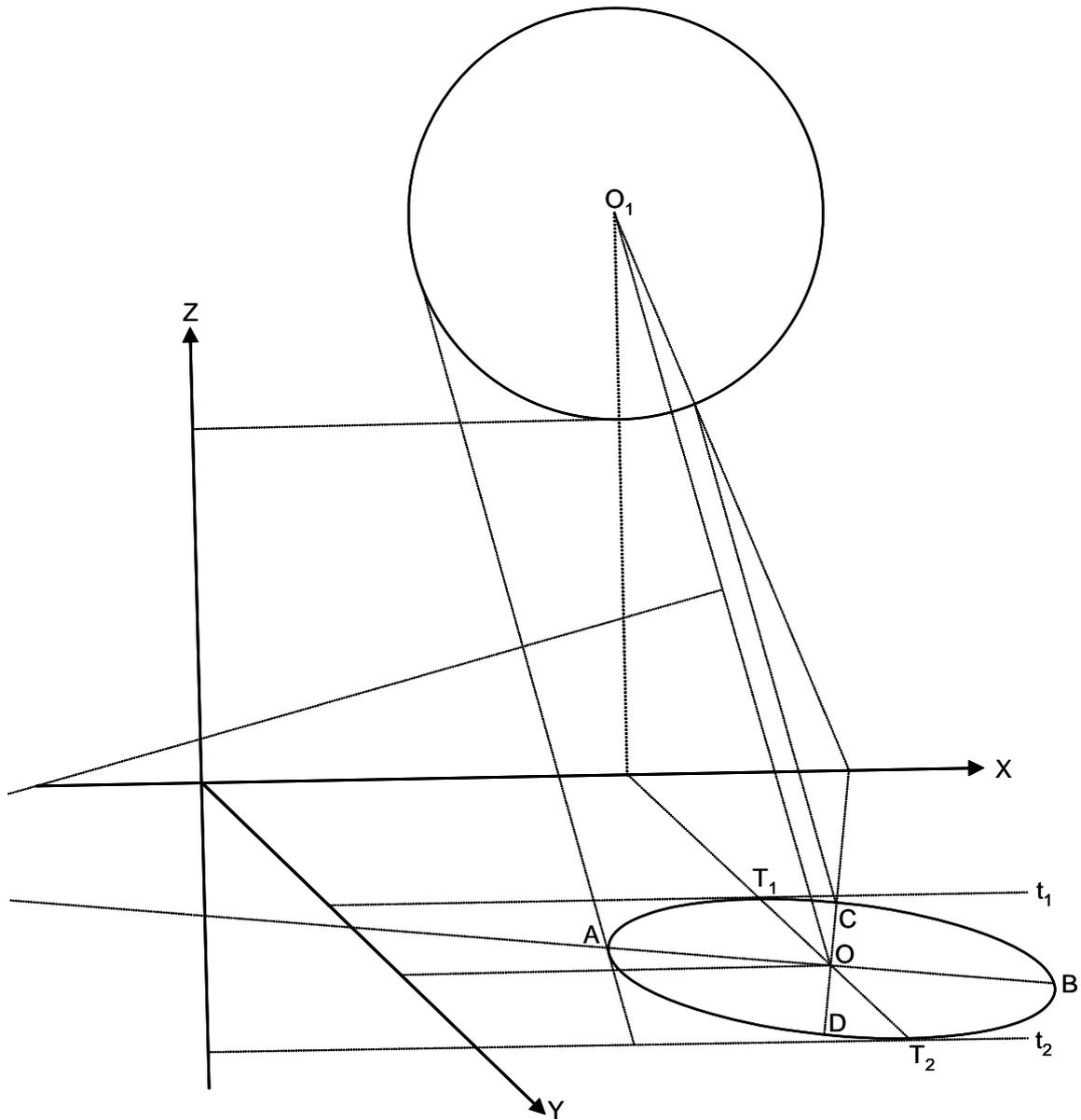
El ángulo  $XOY = 45^\circ$ .  $O_1$  es el centro rebatido.  $T_1$  y  $T_2$  son los puntos de tangencia, y  $t_1$  y  $t_2$  las tangentes. Los ejes de la elipse son  $AB$  y  $CD$ .
