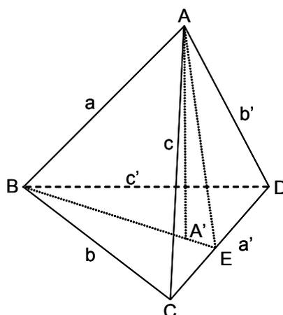
Sea el tetraedro  $ABCD$ , cuyas aristas opuestas ortogonales, son  $aa'$ ,  $bb'$ ,  $cc'$ . Sea el plano  $ABE$  perpendicular a  $CD$ . La altura  $AA'$  del tetraedro coincide con la altura del triángulo  $ABE$ , siendo  $A'$  el ortocentro del triángulo  $BCD$ . Se tiene:  $a^2 = AE^2 + BE'^2 - 2 \cdot BE \cdot A'E$ ,
