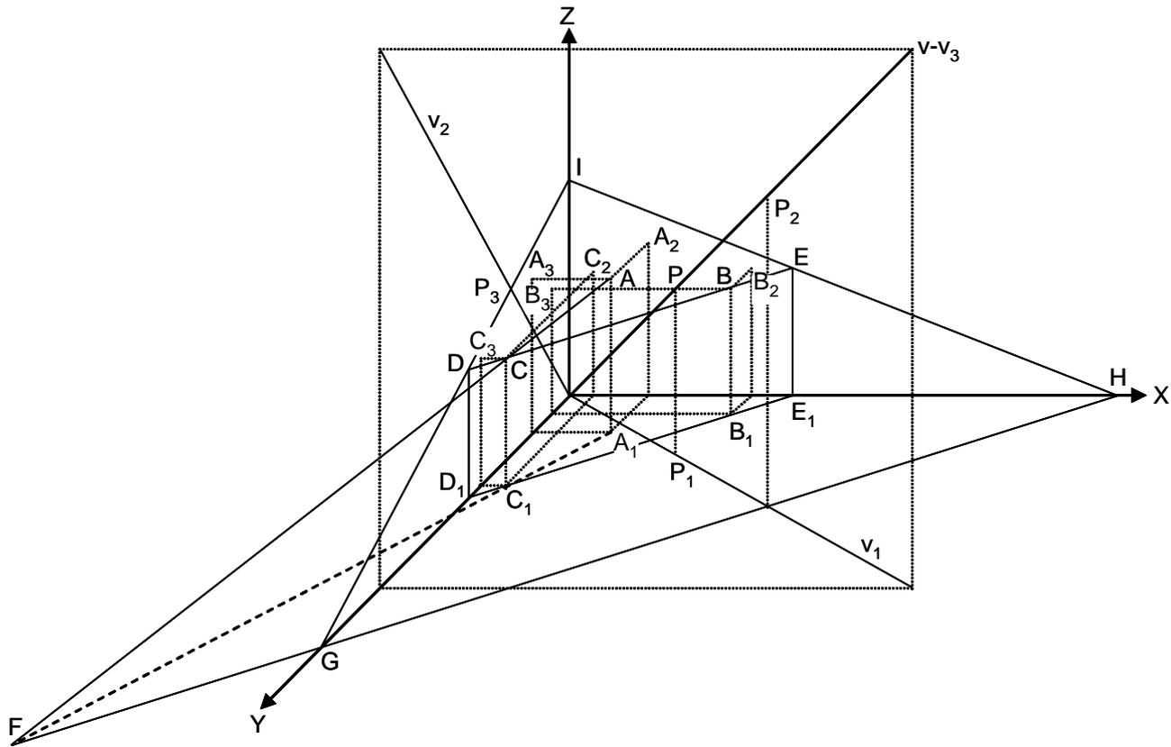
La recta dada es la bisectriz del triedro  $OXYZ$ , siendo sus proyecciones  $v_1$ ,  $v_2$  y  $v_3$ . Las trazas del plano  $ABC$  forman el triángulo  $GHI$ . La intersección es el punto  $P$ .
