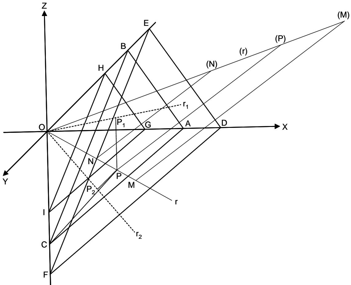
$ABC$  es el triángulo de trazas del plano dado. El punto de corte con  $r$ , perpendicular a dicho plano por  $O$ , es el punto  $P$ . El abatimiento de  $P$  es  $(P)$ , siendo  $(M)$  y  $(N)$  los puntos a distancia de 3 cm a derecha e izquierda de  $(P)$ . Deshaciendo los abatimientos, se obtienen  $M$  y  $N$ . Los planos pedidos son  $DEF$  y  $GHI$ .
