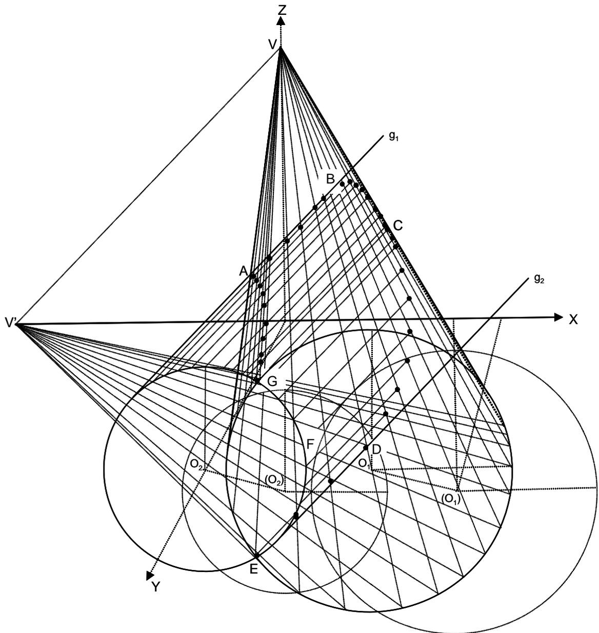
Se utilizan como planos auxiliares los que pasan por la paralela a la generatriz del cilindro trazada por el vértice del cono. Se trata de una mordedura limitada por las generatrices  $AB$  y  $DE$ , y por el arco  $GFE$ . Se ha supuesto que el cilindro es transparente.
