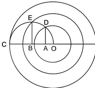
Se divide el radio  $OC$  en partes proporcionales a los números dados:  $OA$ ,  $AB = 2 \cdot OA$  y  $BC = OB$ . Se traza una semicircunferencia de diámetro  $OC$ , y se levantan las perpendiculares  $AD$  y  $BE$ . Las cuerdas  $OD$  y  $OE$  son los radios de los círculos pedidos, pues las áreas de los círculos son proporcionales a los cuadrados de los radios, y estos cuadrados lo son a los números dados.
