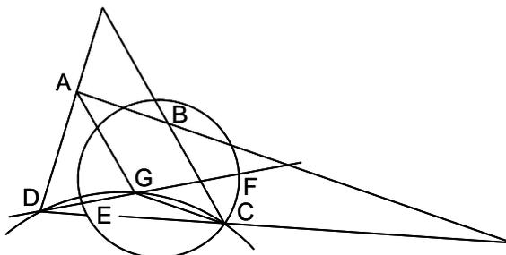
Se traza  $AG$ , paralelo e igual a  $BC$ . Siendo  $\widehat{DCG} = \widehat{AB, CD}$ , el vértice  $C$  se encuentra en el arco capaz de este ángulo trazado sobre  $DG$ . Sean  $E$  y  $F$  dos puntos que dividen a  $DG$  en la relación dada  $\frac{AB}{CD}$ . La circunferencia de diámetro  $EF$ , corta en  $C$  al arco capaz anterior. Las paralelas  $CB$  a  $AG$ , y  $AB$  a  $GC$ , determinan el vértice  $B$ .
