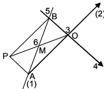
Aplicando el teorema de Brianchon, se tiene que  $AP$  es  $(1 - 4)$ ,  $BP$  es  $(5 - 2)$ , y uniendo  $P$  con  $O$  (3) da  $M$ , punto de contacto. En el paralelogramo  $AOBP$ , la diagonal  $AB$ , que es la tangente, queda dividida en dos partes iguales por el punto de contacto  $M$ .
