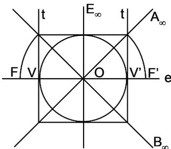
Las tangentes a la hipérbola dada, trazadas desde el centro  $O$ , son sus asíntotas. Se hallan las polares de  $A_\infty$  y  $B_\infty$  (asíntotas de la hipérbola), que son las asíntotas de la recíproca, que coinciden con las de la directa. Para hallar los vértices, se determina el polo  $E_\infty$  del eje  $e$ , respecto a la directriz. Para ello se trazan las tangentes  $t$  a la directriz, cuyos polos  $V$  son los vértices pedidos.
