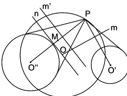
El lugar geométrico de los centros de los círculos que cortan ortogonalmente a  $O'$  y al círculo "degenerado"  $P$ , es su eje radical  $m$ . El lugar geométrico de los centros de los círculos que cortan diametralmente a  $O''$  y al círculo "degenerado"  $P$ , es la recta  $n$ , simétrica del eje radical  $m'$  de  $P$  y  $O''$ , respecto al punto medio  $M$  de  $O''P$ . El punto  $O$  de intersección de  $m$  y  $n$ , es el centro del círculo pedido, cuyo radio es  $OP$ .
