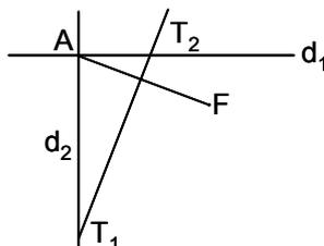
Las directrices  $d_1$  y  $d_2$  se cortan en  $A$ . Se traza la mediatriz de  $AF$  que es la tangente común, y por tanto sus intersecciones con  $d_1$  y  $d_2$  dan  $T_2$  y  $T_1$ ,
