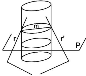
Sea  $m$  la perpendicular común a  $r$  y  $r'$ . La recta intersección de dichos planos perpendiculares entre sí, forma una superficie cilíndrica, pues un punto de ella que esté en el plano perpendicular a  $r$  y  $r'$  conteniendo a  $m$ , está en el arco capaz de  $90^\circ$  sobre  $m$ . Luego el lugar pedido es la intersección de la superficie cilíndrica con el plano dado  $P$ . Como este plano es perpendicular a una de las dos rectas dadas, la intersección es una circunferencia.
