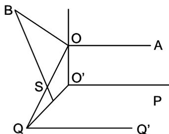
El lado  $OB$  está en el plano perpendicular a  $OA$  por  $O$ . Cualquier plano  $SOA$  corta al plano  $P$  según una paralela a  $OA$ . El plano  $SOB$  corta al plano  $P$  según una recta perpendicular a  $QQ'$ , es decir paralela a  $O'Q$ . Luego  $S$  debe estar sobre el plano perpendicular a  $OA$  en  $O$ , que es su lugar geométrico.
