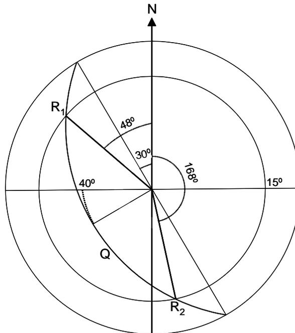
La solución  $R_1$  corresponde a la dirección  $N - 48^\circ - W$ , y la  $R_2$  a la dirección  $N - 168^\circ - E$ .
