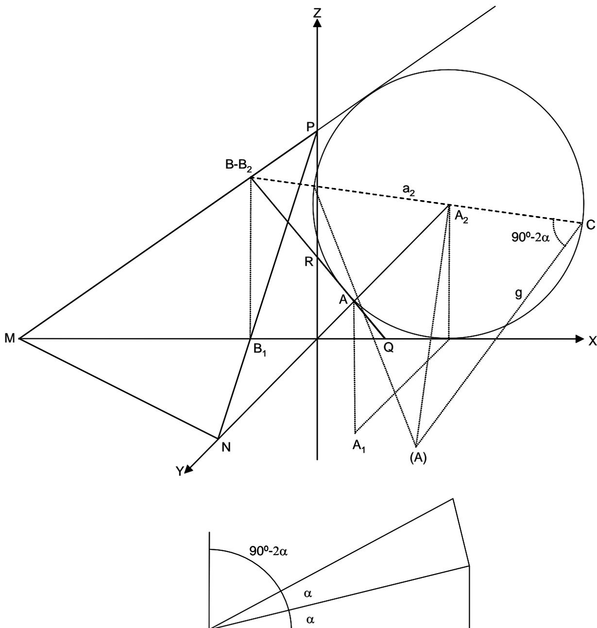
(A) es el abatimiento de  $A$  sobre  $XZ$ , siendo  $a_2$  la charnela. En el diagrama inferior se obtiene el ángulo  $90^\circ - 2\alpha$ . Las trazas del plano pedido deben pasar por  $A_2$  y  $B_2$ , y ser tangentes a la circunferencia. Hay dos soluciones, los planos  $MNP$  y  $QAR$ .
