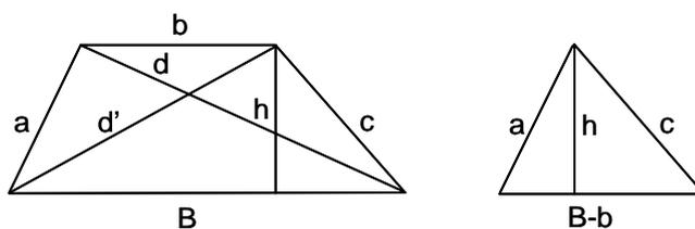
En el triángulo de la figura de la derecha, se tiene:  $h = \frac{2\sqrt{p(p-B+b)(p-a)(p-c)}}{B-b}$ , siendo  $p = \frac{B-b+a+c}{2}$ . En la figura de la izquierda:  $\sqrt{d^2-h^2} + \sqrt{c^2-h^2} = B$ ,  $d^2 = (B - \sqrt{c^2-h^2})^2 + h^2$ . Por tanto,  $d = \sqrt{(B - \sqrt{c^2-h^2})^2 + h^2} = \sqrt{B^2 + c^2 - 2B\sqrt{c^2-h^2}}$ ,  $d' = \sqrt{B'^2 + a^2 - 2B\sqrt{a^2-h^2}}$ .
