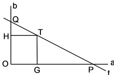
Sean  $a$  y  $b$  los ejes, y  $t$  una tangente a la cónica, siendo  $T$  el punto de tangencia. La tangente corta a los ejes en  $P$  y  $Q$ , y son  $G$  y  $H$  las proyecciones de  $T$  sobre los ejes.  $Q$  es el polo de  $TH$ , y  $P$  el de  $TG$ . Por tanto, siendo  $A$  y  $A', B$  y  $B'$ , los vértices, se tiene  $OA^2 = OG \cdot OP$  y  $OB^2 = OH \cdot OQ$ , con lo que se obtienen los ejes en magnitud.
