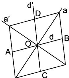
Sean los diámetros conjugados  $d$  y  $d'$  ( $d$  está limitado por los puntos  $A$  y  $B$ ). Las asíntotas  $a$  y  $a'$ , son las bisectrices de los ángulos formados por  $d$  y  $d'$ . El paralelogramo formado por las tangentes en  $A$  y  $B$ , es un rombo que limita a  $d'$  en los puntos  $C$  y  $D$  ( $CD = AB$ ).
