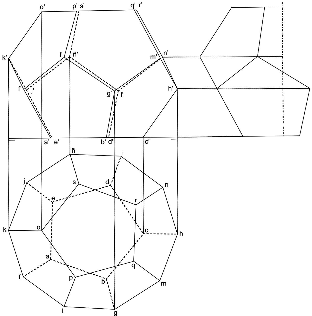
La proyección  $de$  de la arista  $DE$  perteneciente a la cara  $ABCDE$ , apoyada en el plano  $H$ , forma un ángulo de  $15^\circ$  con la línea de tierra. El pentágono  $OPQRS$  está girado  $36^\circ$  respecto al  $ABCDE$ . En el croquis de la derecha se ha dibujado la sección principal que determina las alturas de los planos donde se sitúan los vértices  $FGHIJ$  y  $KLMNÑ$ .
