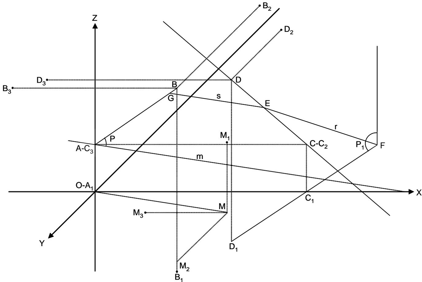
1. El plano auxiliar  $P$  pasa por  $AB$  y por la paralela a  $OM$  trazada por  $A$ . El plano auxiliar  $P_1$  es vertical y pasa por  $CD$ . La intersección de ambos planos es  $EF$ . La recta pedida es  $EG$ .
