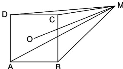
El triángulo  $MBC$  genera un volumen  $\frac{2\pi}{3}(d-a)^2a$ . El triángulo  $MDA$  genera un volumen  $\frac{2\pi}{3}(d+a)^2a$ . Los triángulos  $MCD$  y  $MAB$  generan en conjunto un volumen  $\frac{2\pi}{3}a^22a$ . La suma de los cuatro volúmenes es:  $\frac{4\pi}{3}a(2a^2 + d^2)$ . Para  $a = 2$  y  $d = 3$ , esta suma es  $\frac{136\pi}{3}$ .
