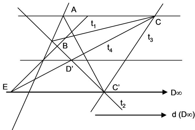
Sean  $t_1, t_2, t_3$  y  $t_4$  las tangentes dadas. Sea  $AB$  el eje perspectivo correspondiente a la base  $t_1$  y a  $t_2$ . Y sea  $d$  la dirección dada ( $D_\infty$ ). Se trata de hallar en la tangente  $t_2$ , el homólogo  $D'$  de  $D_\infty$ . Como  $C'D_\infty$  y  $D'C$  se cortan en el eje perspectivo (punto  $E$ ), queda determinado  $D'$  (intersección de  $CE$  con  $t_2$ ). La paralela a  $d$  desde  $D'$ , es la tangente pedida.
