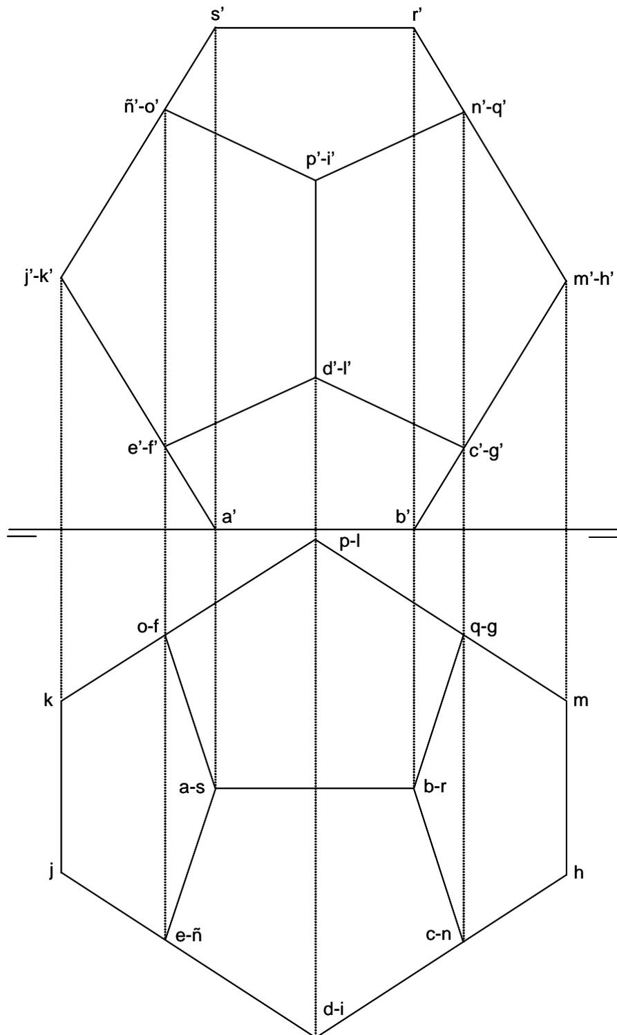
Las aristas  $AB$  y  $KL$  se proyectan en verdadera magnitud, siendo sus proyecciones sobre  $H$ , paralelas a la línea de tierra. La figura formada por  $engf$  es un cuadrado de lado la diagonal del pentágono regular que tiene por lado la arista del dodecaedro. La proyección sobre el plano  $V$  es igual a la del plano  $H$  girada  $90^\circ$ .
