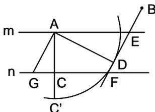
Sean  $AG$  y  $BF$  las paralelas trazadas por  $A$  y  $B$ , y sea  $AC$  la distancia entre  $m$  y  $n$ . Se multiplica  $AC$  por la razón dada, obteniéndose  $AC'$ . Se traza la circunferencia de centro  $A$  y radio  $AC'$ , y se traza por  $B$  la tangente  $BD$  a dicha circunferencia, que corta en  $E$  y  $F$  a  $m$  y  $n$ . Se traza la paralela  $AG$  a  $BD$ . El paralelogramo pedido es el  $AEFG$ , pues en los triángulos semejantes  $AGC$  y  $ADE$ , se tiene
