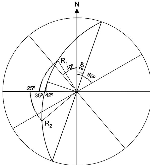
El plano de la capa  $Q$  está definido por las dos rectas  $R_1$  y  $R_2$ , siendo su dirección  $N - 20^\circ - E$ , su inclinación  $42^\circ$ , buzamiento  $NW$ .
