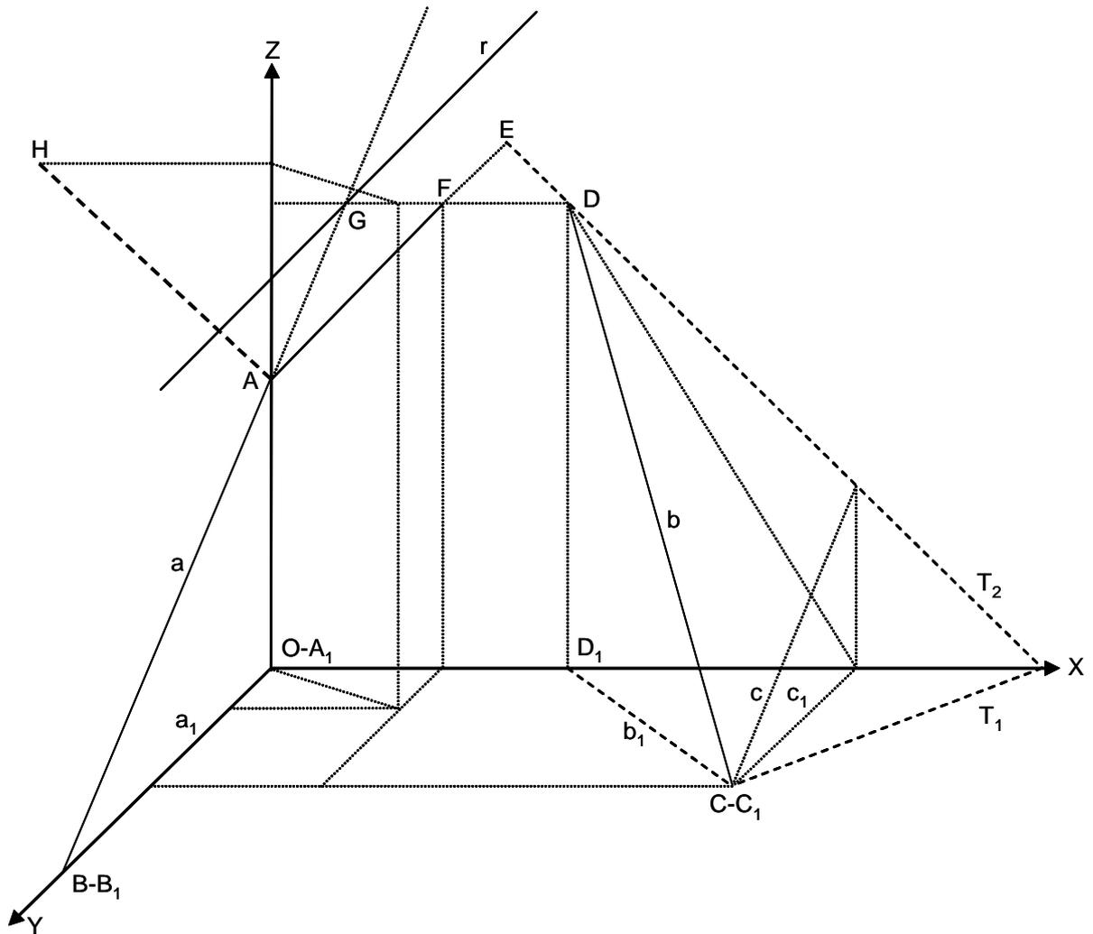
$CC_1$  es la recta paralela a  $AB$  por  $C$ . El plano  $P$  pasa por  $CD$  y  $CC_1$ , siendo sus trazas  $T_1$  y  $T_2$ . La perpendicular por  $A$  a  $P$ , es  $AF$ , cuya intersección con  $P$  es  $F$ . La mínima distancia es  $AF$ , y su verdadera magnitud es  $AH$ . La recta pedida es  $r$ , paralela a  $AF$ .
