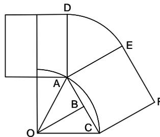
En la figura se ha representado el cuadrante superior derecho. Los vértices del exágono son A y C. Sobre AC se ha construido el cuadrado ACFE, cuyo vértice E se ha unido al vértice D mediante el arco DE de centro A y radio  $AE = a$ . El área pedida corresponde a seis veces el área de  $OADEFKO = 6(S_{OAC} + S_{ADE} + S_{ACFE})$ .
