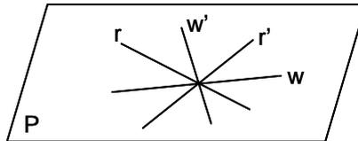
En el plano  $P$  formado por las dos rectas  $r$  y  $r'$ , se trazan las bisectrices  $w$  y  $w'$ . Levantando por  $w$  y  $w'$  planos perpendiculares al formado por  $r$  y  $r'$ , se obtiene el lugar pedido.
